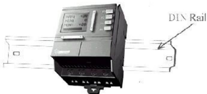
Rys 3.1 Montowanie sterownika SR na szynie DIN ( 35 mm )
