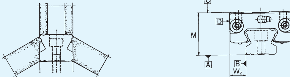
Rys. 3. Obróbka szlifierska i punkty odniesienia
